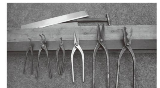
**板** 金屋の鋏。鋼板を直線あるいは曲線に切る道具で、長く直線を切る「まとも」 急なカーブを切る「えぐり」 直線・曲線問わずあらゆる場面で使う「柳刃」等、鋏によって呼び名がある。
