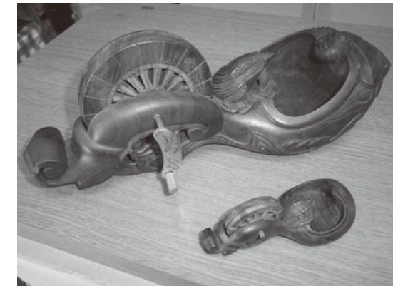
**墨壺** 墨は、木材等に長く正確な直線や、ゆるい曲線を引く為の道具で、竹製の墨刺を用いて文字や短い線を引く為に必要な墨を蓄えておくものである。糸の先についたカルコの針を材木に刺し、必要な長さまで繰り出した所で糸を張り、軽く弾く事で墨線が材に引かれる。
