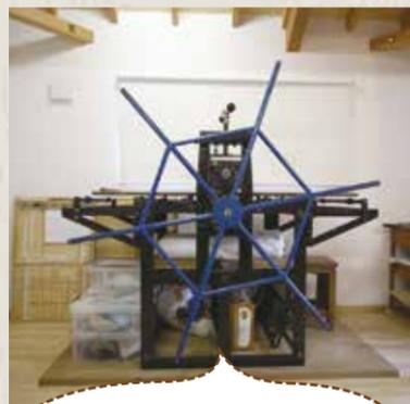
重さ350kgの銅版画印刷機。床下には土間コンクリートを打ち、床補強しています。
