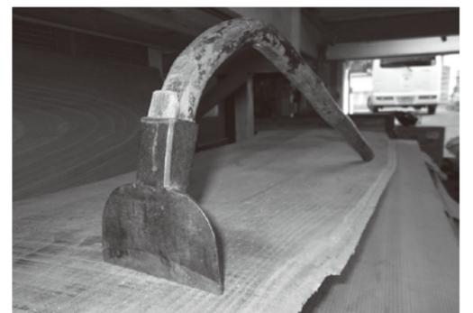
鉦は古墳時代から存在し、世界各国、似たような形で使われてきた歴史のある道具である。刃の形状は使用する地域によって異なるが、多くの大工が使用するものは「両刃」で刃先は真っ直ぐなものである。柄は主に槐を湾曲させたものを用い、袋状の刃の付け根に柄を差し込み、楔を用いて抜けないようにしている。鉦は材を形成する為の荒加工の道具で、梁に取り付く束との接合部の切り欠き等にも多く使われていた。鋸があまり普及していない頃は樹木を加工する際に斧で伐採し、繊維方向に引き割った材を鉦で研って木ごしらえをし、目に触
